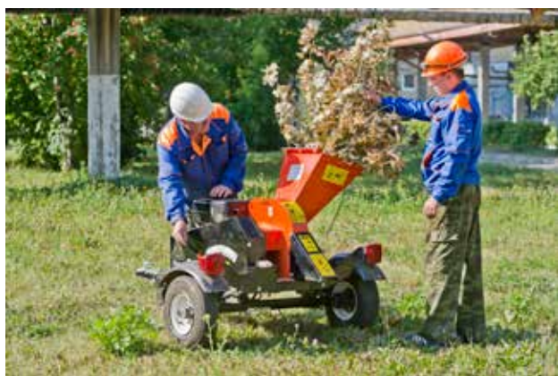
Дробильная установка для утилизации древесных отходов
